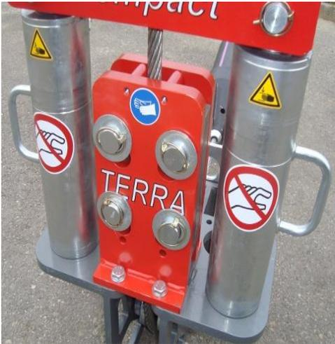
→ El X 300 C puede ser levantado desde sus dos argollas para elevación.
