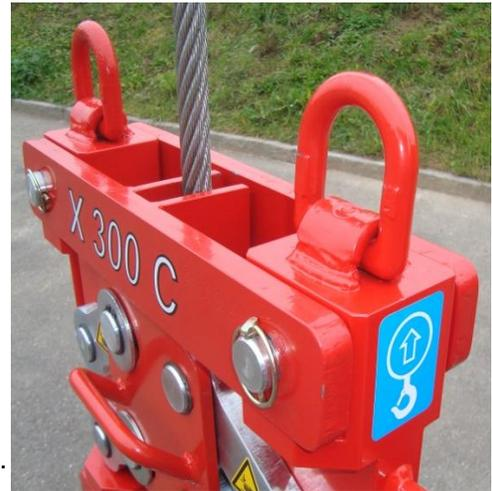
← Ambos cilindros hidráulicos producen una fuerza de tracción de 300 kN (30 toneladas / 33 toneladas americanas).
