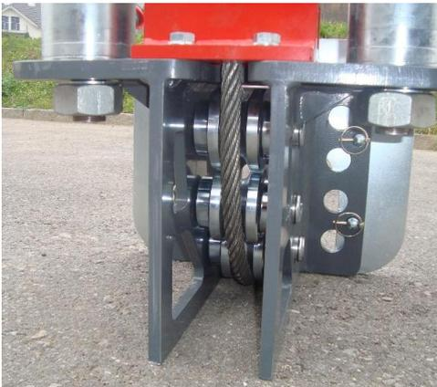
← Las poleas guían el cable de posición horizontal a la posición vertical.
