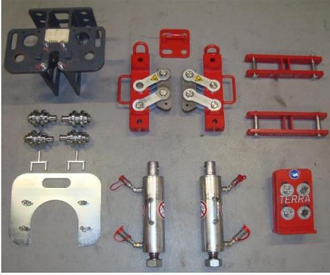
← El X 300 C puede ser fácilmente desmontado en componentes más ligeros de 45 kg (100 libras). De esta manera dos personas la pueden montar en una cámara estrecha para trabajar.
