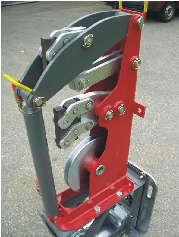
El sistema de mordazas trae el cable fácilmente a través del terreno tirando de él con rapidez y seguridad.
