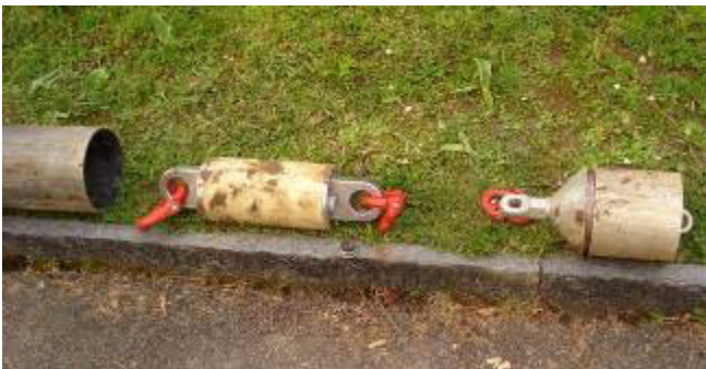
La unidad de medición se monta entre el cono de expansión y el conector de expansión. La funda de protección protege la unidad de medición de los daños que pueden causar los fragmentos rotos de la tubería antigua.
