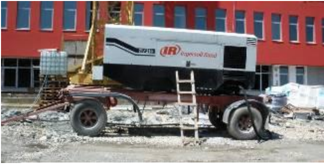
↑ El compresor de aire IR produce 21.5 m 3 /min @ 21 bar (750 cfm @ 300 psi).
