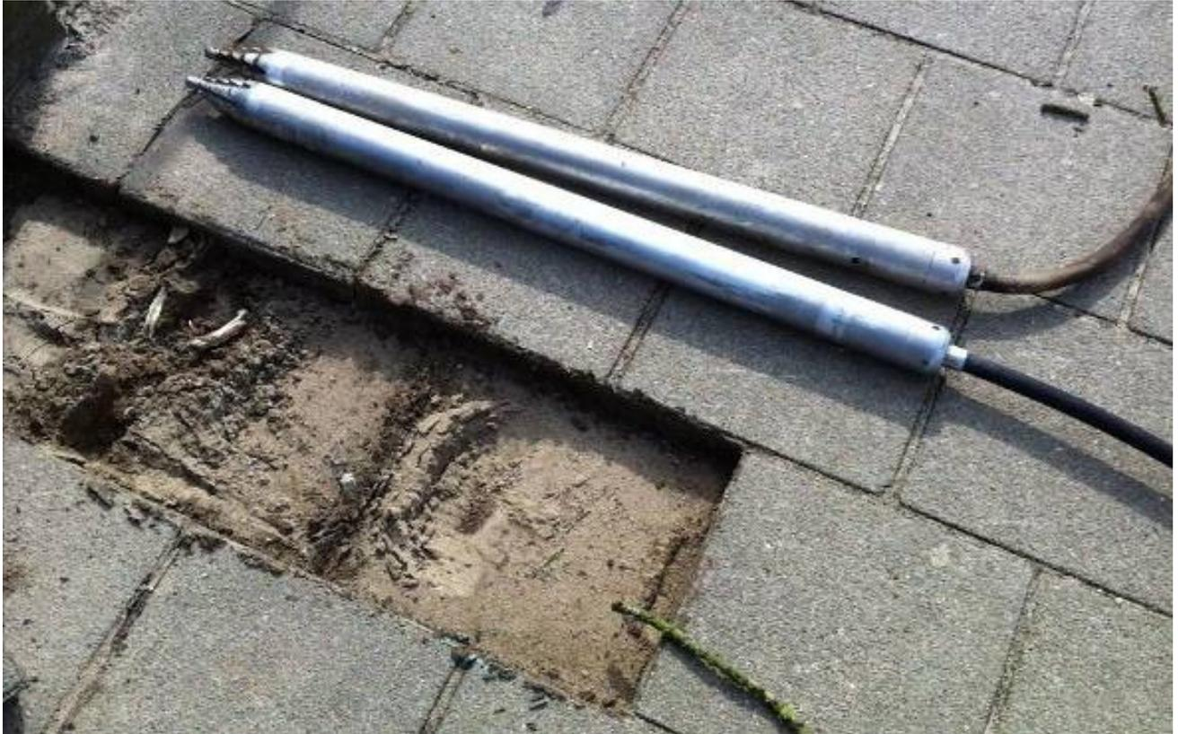
En Holanda la mayor parte de las losas de las aceras son de 0,30 x 0,30 m (1 pie x 1 pie). El TERRA-HAMMER T 055 SK mide sólo 0,90 m (3 pies) de largo. Por lo tanto, sólo 3 losas de la acera deben ser removidas para preparar el pozo de lanzamiento para las conexiones domiciliarias. Esta fosa o pozo de lanzamiento es de 0,90m x 0,30m (3 pies x 1 pie) es lo suficientemente grande para este TERRA-HAMMER. La profundidad del foso de lanzamiento es de 0,55 m (22 ").
