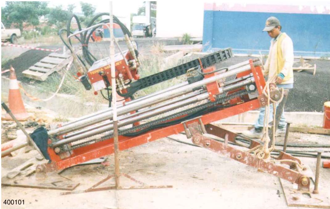
Foto izquierda: La cureña TERRA MINI- JET/LV con equipamiento para arranque en la superficie.
