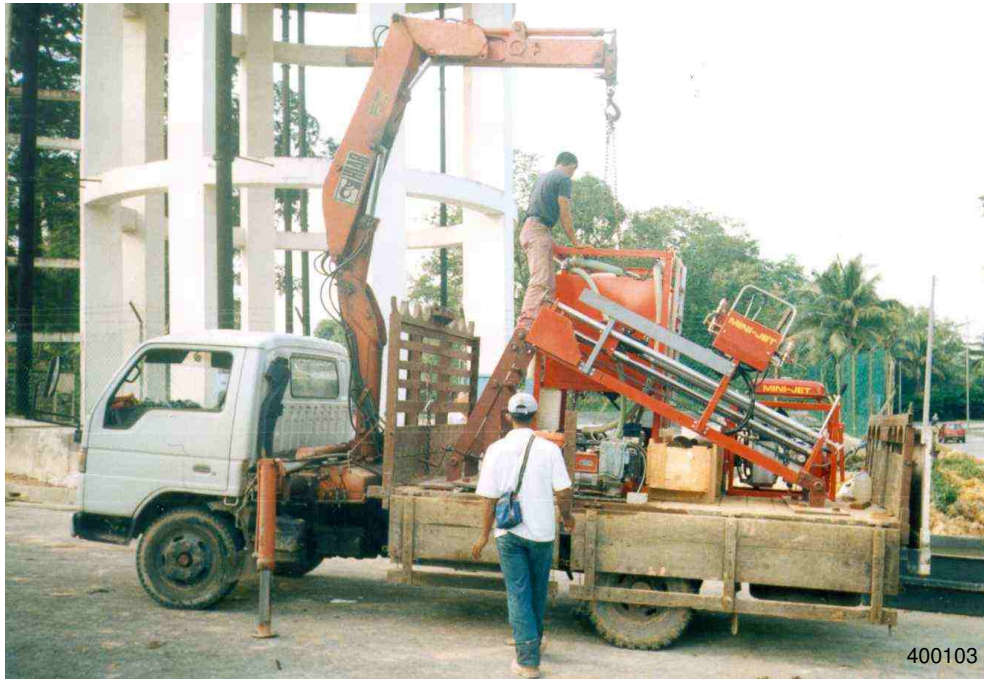
Foto izquierda: Para el transporte del sistema de perforación TERRA MINI-JET/LV completo (cureña, módulo mezclador, unidad hidráulica y herramientas de perforación) no se necesita más que un camión pequeño.
