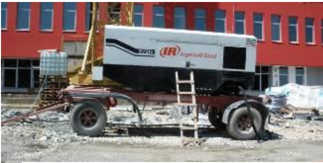
↑ Der Druckluft-Kompressor von Ingersoll Rand liefert 21.5 m 3 /min bei 21 bar.
